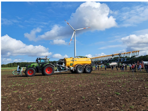
Schlepper mit Güllefass und angebrachtem NIR-Sensor während der Demonstration.
